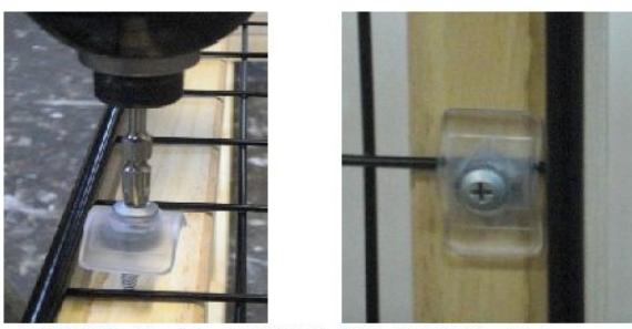
透明カバーは、細い線材を覆うように取り付けて下さい。
