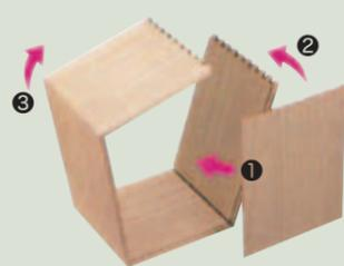
①底板を側板の溝に差し込みます。
